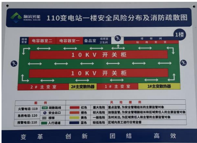
110KV 变电站一楼布设
